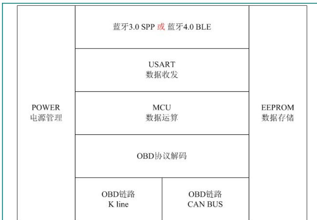
Fig 2. 产品内部原理框图
